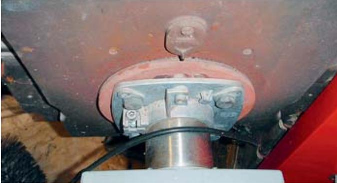
Brandschutzplatte aus Asbestzement
